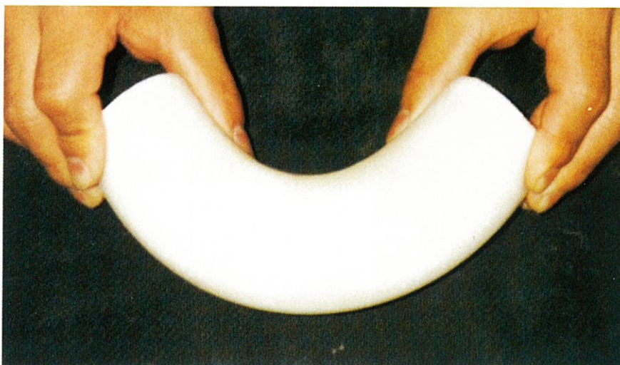
アロンスーパーグラウト-Cの硬化物を 屈曲させた状態
