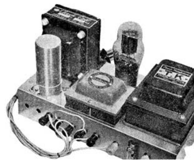
本機の電源部
