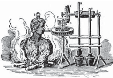
第2図 蒸気車——蒸気タービンの原理
